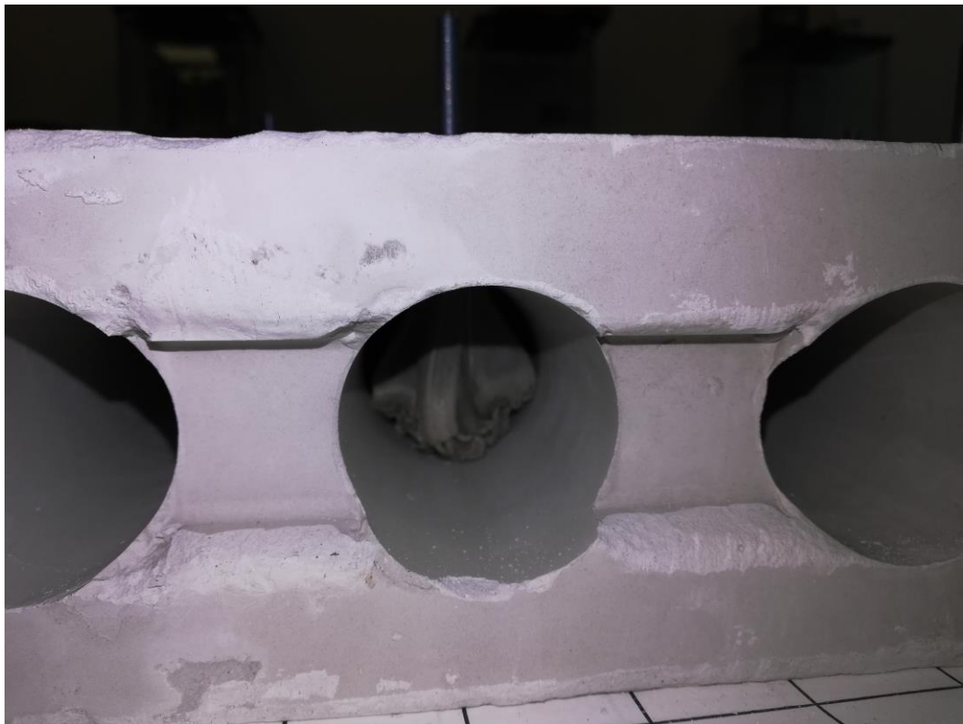
Рис. 6 а) Химический анкер FIS VS 300 Т с резьбовой шпилькой FIS А М 8х90 и сетчатой гильзой FIS А 12х50 К, установленный в пустотелую пазогребневую плиту Волма; б) участок блокировки химического анкера FIS VS 300 Т в пустоте пазогребневой плиты Волма.
