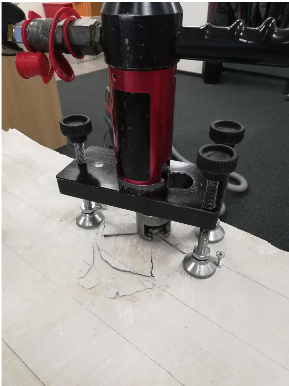
Рис. 8 а) Домкрат гидравлический Hydrojaws 2000 Master Tester Kit в момент испытания на вырыв универсального дюбеля DUOPOWER 8x40 (шуруп Ø6 мм), установленного в пустотелую пазогребневую плиту Волма.
